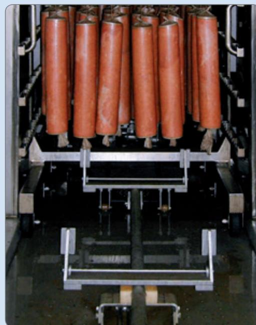
Одновременно с процессом охлаждения можно загружать продукт в освободившуюся зону копчения и варки и начинать новый цикл. Гибкость – отличительная черта этих установок, т.к. для работы используются стандартные напольные рамы и одновременно можно обрабатывать разные виды продукции.
