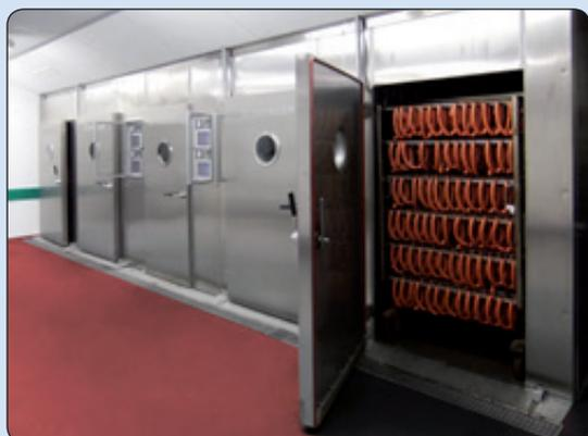
Благодаря тому, что процесс парового копчения AUTOTHERM® проходит в условиях максимальной влажности и занимает минимальное количество времени, время копчения сокращается до 40%, а весовые потери до 3% по сравнению с традиционным способом копчения.
