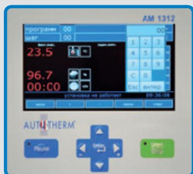
Управление AM 1312 оптимально для установок дефростации, интенсивного охлаждения, варки и запекания, а также для установок холодного копчения и климатического созревания продукции. Управление оснащено 7-дюймовым TFT дисплеем и рядом интерфейсов.
